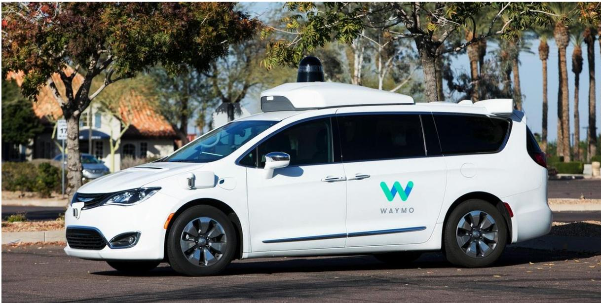
Abb. 2 Kristoffer Tripplaar/Almy, Inhalt: autonomes Google Waymo Auto mit gut erkennbarem Lidar-Sensor auf dem Dach und Radar-Sensoren vorne in der Mitte und auf der Seite über dem Vorderrad
