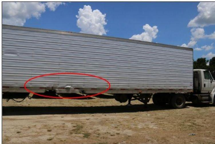
*Abb. 7 The trailer that Brown's Tesla Model S hit, with impact damage circled (Pic: US NTSB); Übersetzt: Der Sattelschlepper mit dem Browns Tesla Model S kollidierte, mit einem roten Kreis markiert ist zu sehen, wo das Fahrzeug durchgefahen ist (Bild: US NTSB)*
