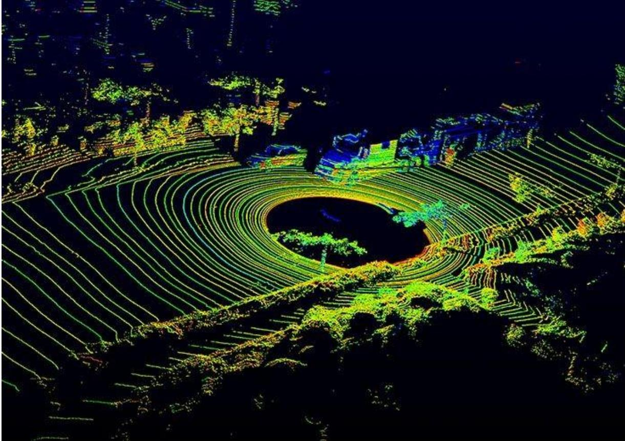
Abb. 3 ein Schnappschuss, wie ein Lidar-System die Umwelt auf dem Dach eines Autos wahrnimmt.
